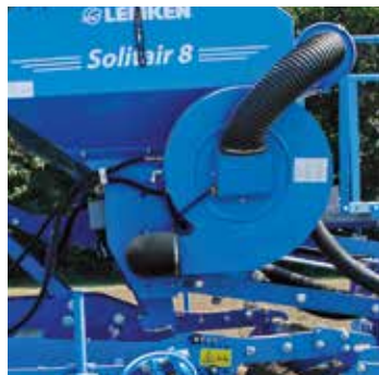
Hydraulicky poháněný ventilátor
