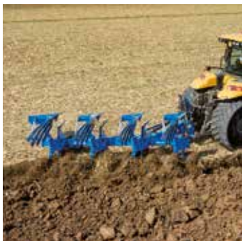
Provedení OF (ON-LAND) pro práci mimo brázdou
