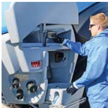
Přimíchávací nádrž s elektronickým ovládacím systémem je optimálně integrována
