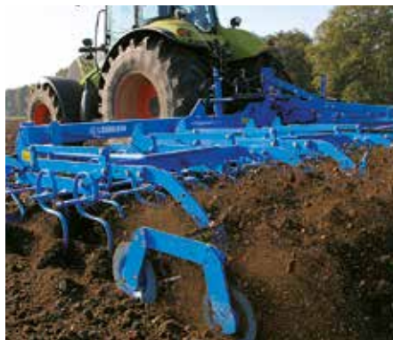
Dvojitě-trubkové a ozubené drobné válce
