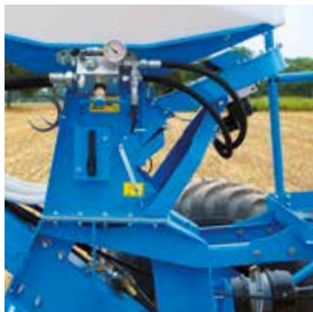
Hydraulický pohon ventilátoru
