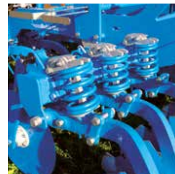
Stabilní jištění proti přetížení
