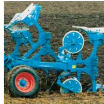
Tandemové pružinové jištění proti přetížení
