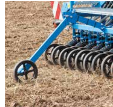
Impulzní kolo s přesným měřením ujeté dráhy
