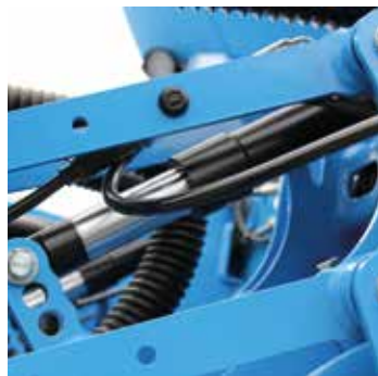
Nastavení tlaku hydraulické secí botky
