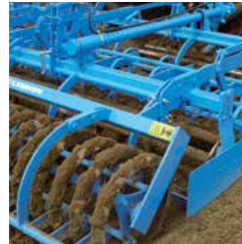
Hydraulické přestavení smykové lišty
