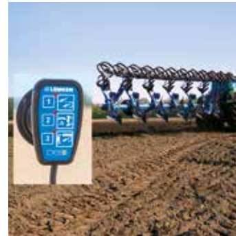
Otáčení pomocí Memory válce a komfortního ovládání
