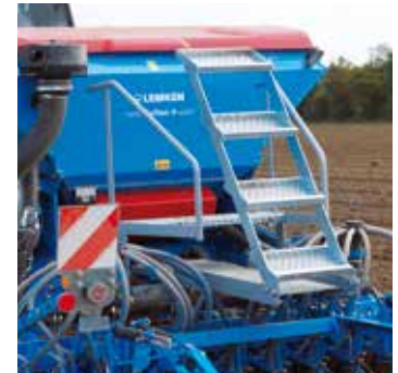
Zlepšený přístup k dávkovacímu ústrojí
