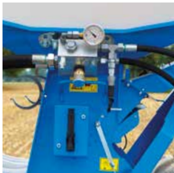
Hydraulický pohon ventilátoru
