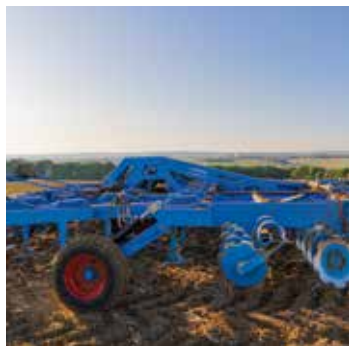
Kombinace diskových bran a polí s šípovými radličkami
