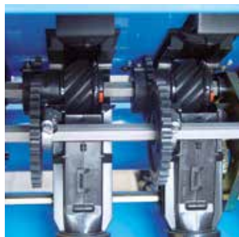
Šestihránný výsevní hřídel s rychlovýměnným zařízením
