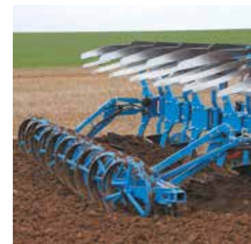
Hydraulicky nastavitelný přítlak
