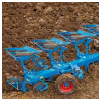
Zadní část pluhu s dobrým kopírováním půdy
