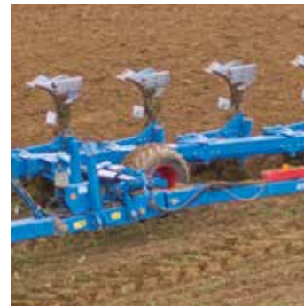
Přední opěrné kolo uvnitř rámu pluhu
