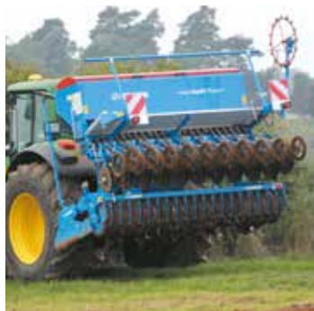
Vhodné přenesení těžiště pomocí hydrauliky
