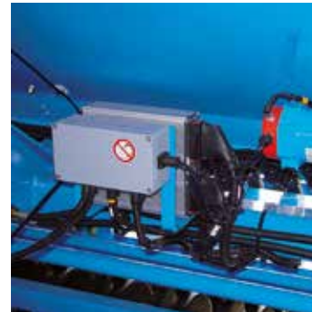
Elektrický výsevní hřídel s precizním dávkováním
