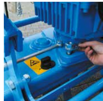
Změna směru otáčení pro nejrůznější podmínky nasazení
