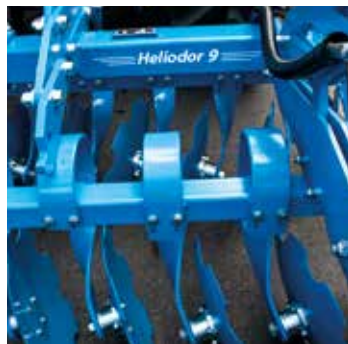
Samostatně nastavitelné disky v oblasti stop kol traktoru
