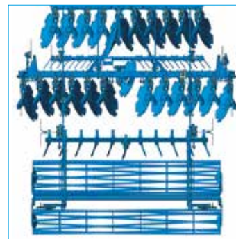
Bez vybočení se symetrickým uspořádáním kotoučů
